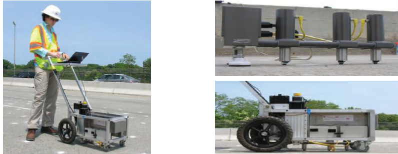
[그림 4-4] 표면초음파법 현장 조사 모습(한국도로공사, 2014)
