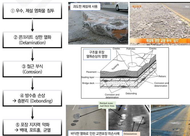
[그림 1-3] 바닥판 열화 손상이 상부 포장에 미치는 영향
