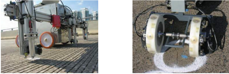
[그림 4-2] 충격반사파 측정 장비와 수신 센서(한국도로공사, 2014)
